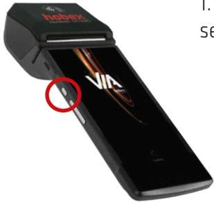
1. Schalten Sie das Gerät durch langes Drücken der seitlich am Gerät befindlichen **Ein/Aus-Taste** ein.
