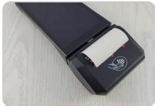
3. Ein bis zwei Zentimeter der Papierrolle herausstehen lassen, Deckel durch leichten Druck schließen.
