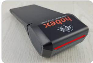
1. Deckel anheben (rote Markierung) und nach hinten klappen um die Abdeckung zu Öffnen.
