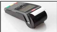
3. Ein bis zwei Zentimeter der Papierrolle herausstehen lassen, Deckel durch leichten Druck schließen.
